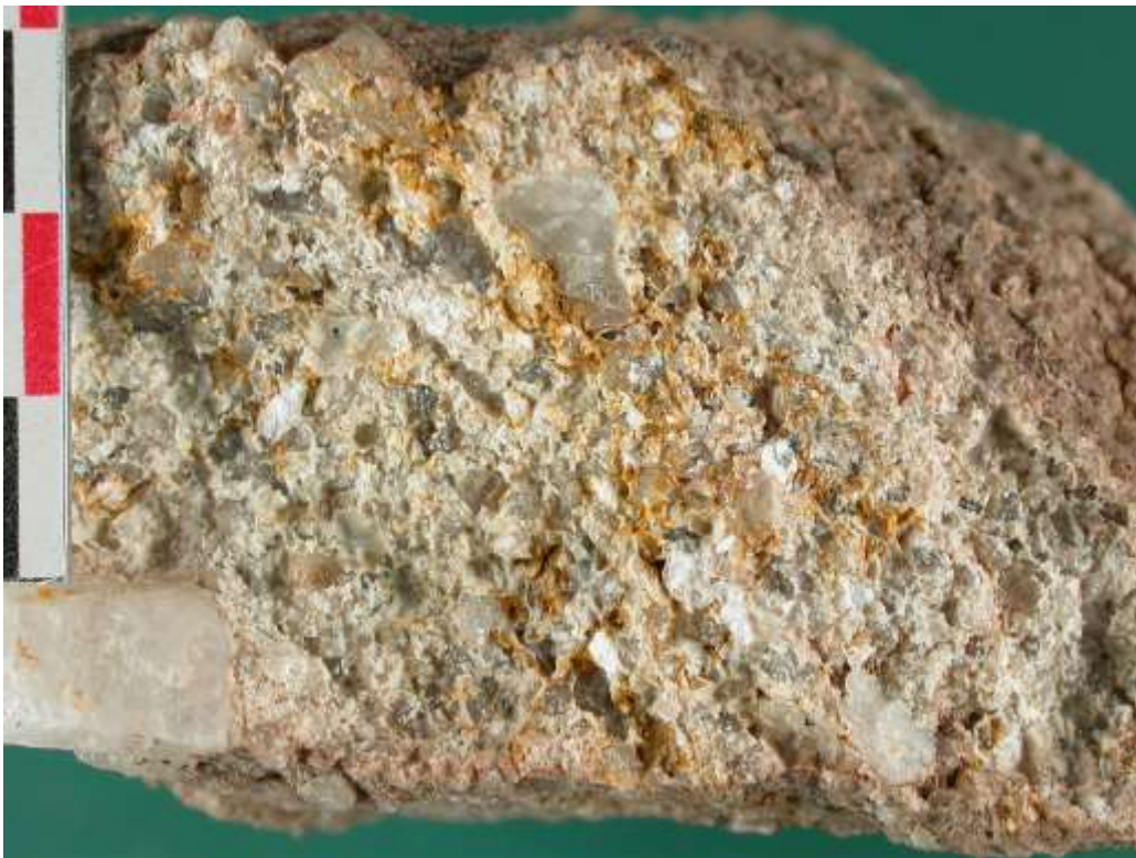
Image 3 : Conglomérat de Saint-Crépin-de-Richemont, Photo macroscopique d'un secteur altéré
